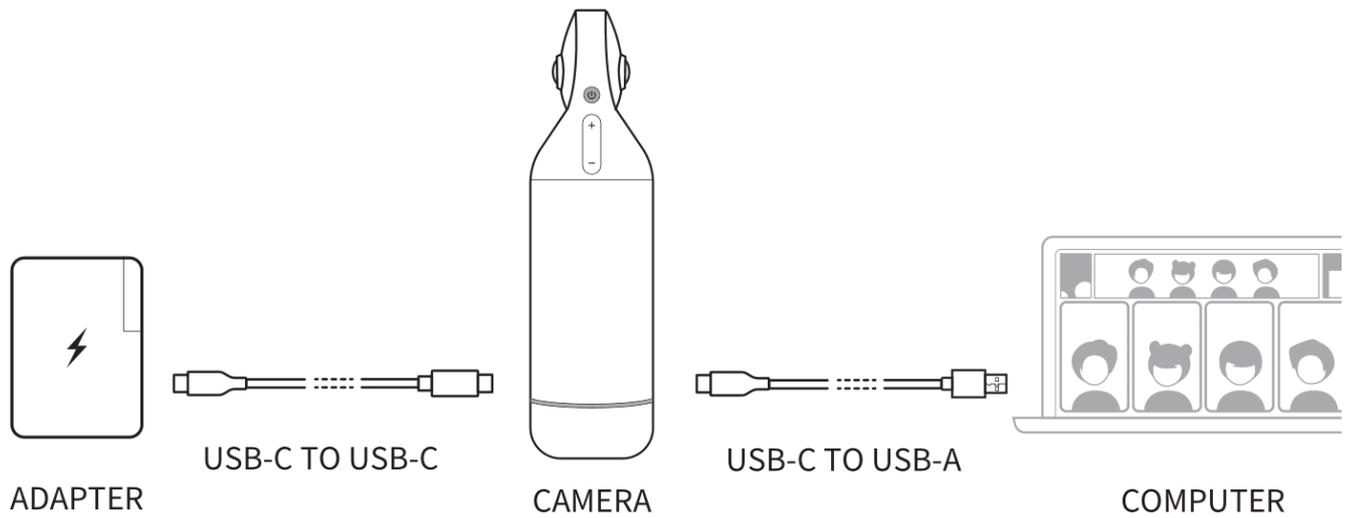
3. Stellen Sie die **Stromversorgung** über das mitgelieferte Netzteil her. Schließen Sie den USB-C-Stecker am Stromanschluss  der Kamera an.
