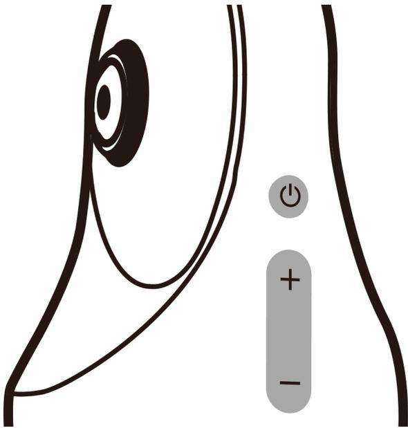
9. Der grün blinkende Farbring signalisiert, dass die Kamera gestartet wird. Wenn die Kamera einsatzbereit ist, leuchtet er dauerhaft grün.
