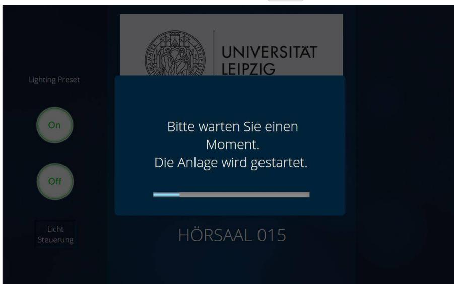
3. Schalten Sie, wenn benötigt, den Projektor durch Druck auf **On** unter dem **Beamer**-Menü auf der linken Seite des Bildschirms an und wählen Sie die Quelle, die Sie nutzen möchten. Die für HDMI und VGA nötigen Buchsen befinden sich im Anschlussfeld.
